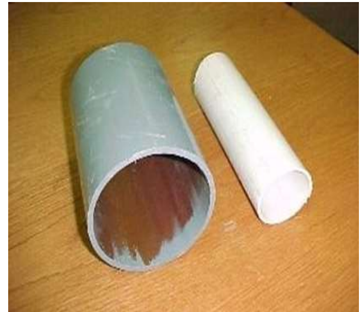
Biofilm en línea tratada con cloro (izquierda) frente a línea de oxidantes mixtos (derecha)
